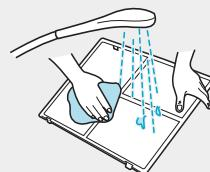
Dopo la pulizia e l'asciugatura all'aria, reinserire il filtro HEPA + Carbone nella sua sede originale e rimettere la griglia del coperchio posteriore.
