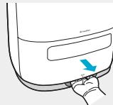
2. Remplir le réservoir d'eau avec l'eau froide du robinet jusqu'à la ligne de marquage située à l'intérieur du réservoir d'eau.
