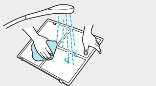
Tras limpiar y dejar secar la rejilla, deslice el filtro combinado HEPA + carbón para situarlo en su ubicación original y vuelva a colocar la rejilla trasera.
